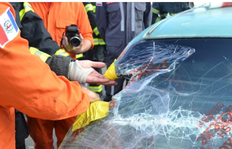
*O Sharpswrap é um material descartável protege as quinas após os cortes na lataria do veículo*
